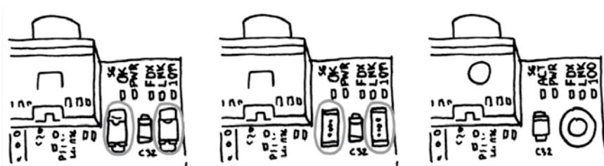
Figura 1.2 – Algumas das placas mais antigas vinham equipadas com fusíveis rearmáveis (à esquerda) para proteger o hub USB. Algumas placas têm os fusíveis rearmáveis substituídos por jumpers (centro), e a última revisão do modelo B os removeram e utiliza o espaço para um furo de montagem (à direita).
