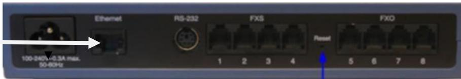
**Passo 2:** Com um clipe de papel ou qualquer outro semelhante pontas objeto, pressione e segure o botão Reset (localizada no painel traseiro) para cerca de seis segundos
