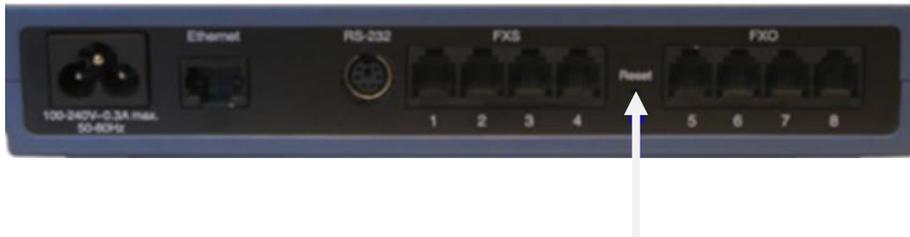
**Passo 3:** Solte o botão Reset. Quando acende o **LED vermelho** na parte frontal do aparelho **FAIL**, é quando o dispositivo restaura as configurações **padrão de fábrica**.
