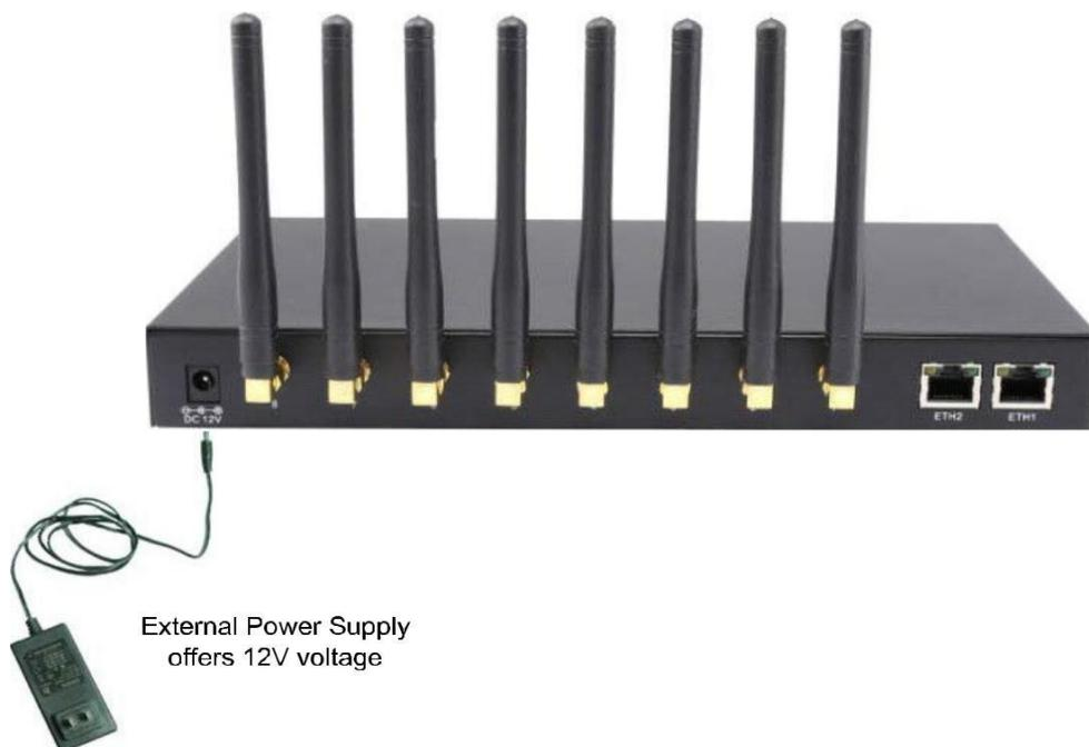
Figura 2-1 Conexão de energia do Gateway SimVox
