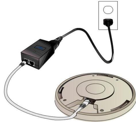
*Diagrama de conexão de energia*
