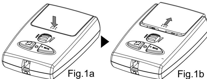
Instale 2 pilhas AA de acordo com a polaridade indicada no compartimento de pilhas (fig.2). É recomendado a utilização de pilhas Alcalinas
