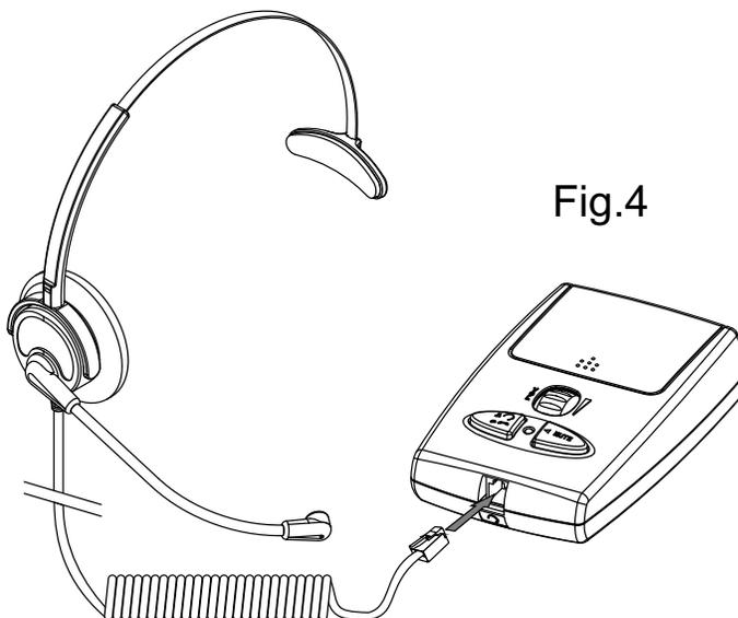
Desconecte o cordão espiralado do telefone e conecte na **Entrada do Microfone** ①. Conecte uma extremidade do **Cabo de Interligação** à **Entrada do Telefone** ② e a outra extremidade ao Telefone ③.
