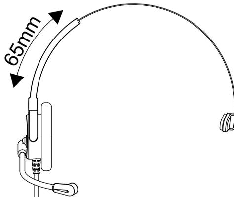
O ajuste da posição do Fone de Cabeça (direita ou esquerda) deve ser efetuado girando o **Suporte de Microfone** a um limite de 300°, sempre passando pela **Tiara**.
