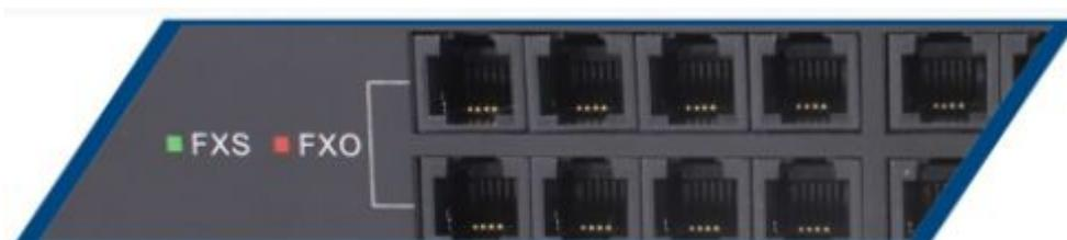
Estrutura modular - as interfaces podem ser no padrão FXO ou FXS de acordo com a configuração escolhida.
