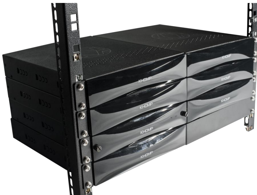
Exemplo de instalação de vários EBS em rack padrão 1U x 19"
