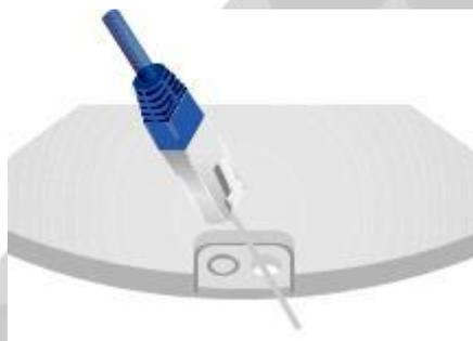
**Note:** O orifício de alimentação irá esticar para acomodar o conector RJ45 e, em seguida, vedar ao redor do cabo.
