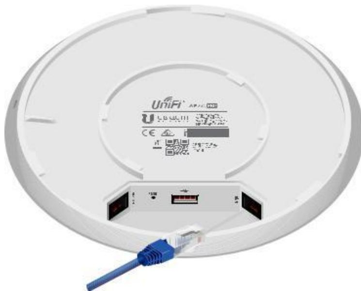
7. Alinhe o notch na borda superior do UNiFi AP com a seta no suporte de montagem.
