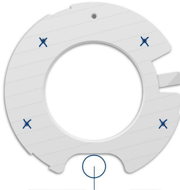
*Orifício de 18mm opcional para alimentação de cabo Ethernet através da parede*
