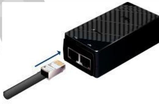
8. Conecte um cabo Ethernet da sua LAN ou computador à porta Ethernet no Adaptador PoE.
