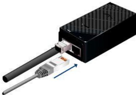
9. Conecte o cabo de energia em sua correspondente porta no adaptador PoE. Conecte a outra extremidade do cabo de alimentação a uma tomada elétrica.
