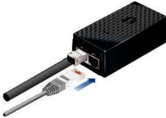
3. Conecte o cabo de energia a porta no adaptador PoE. Conecte a outra ponta em uma tomada.
