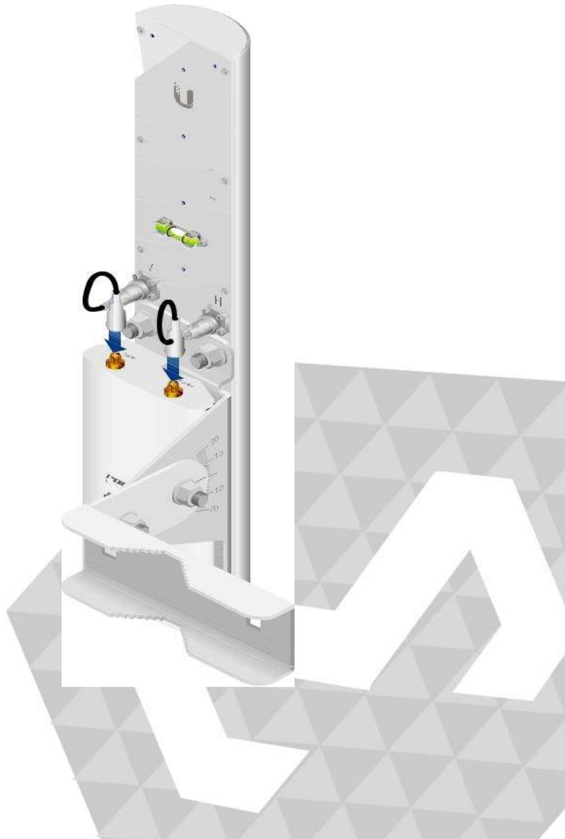
6. Para montar a antena no polo de sustentação, encaixe braçadeira no suporte do polo de sustentação usando dois parafusos de transporte e duas porcas de flange serrilhadas. Aperte á mão apenas.
