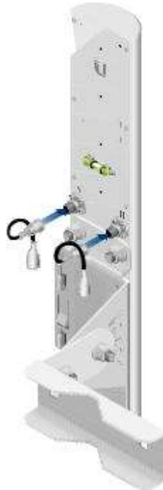
4. Conecte a antena ao conjunto de montagem.
