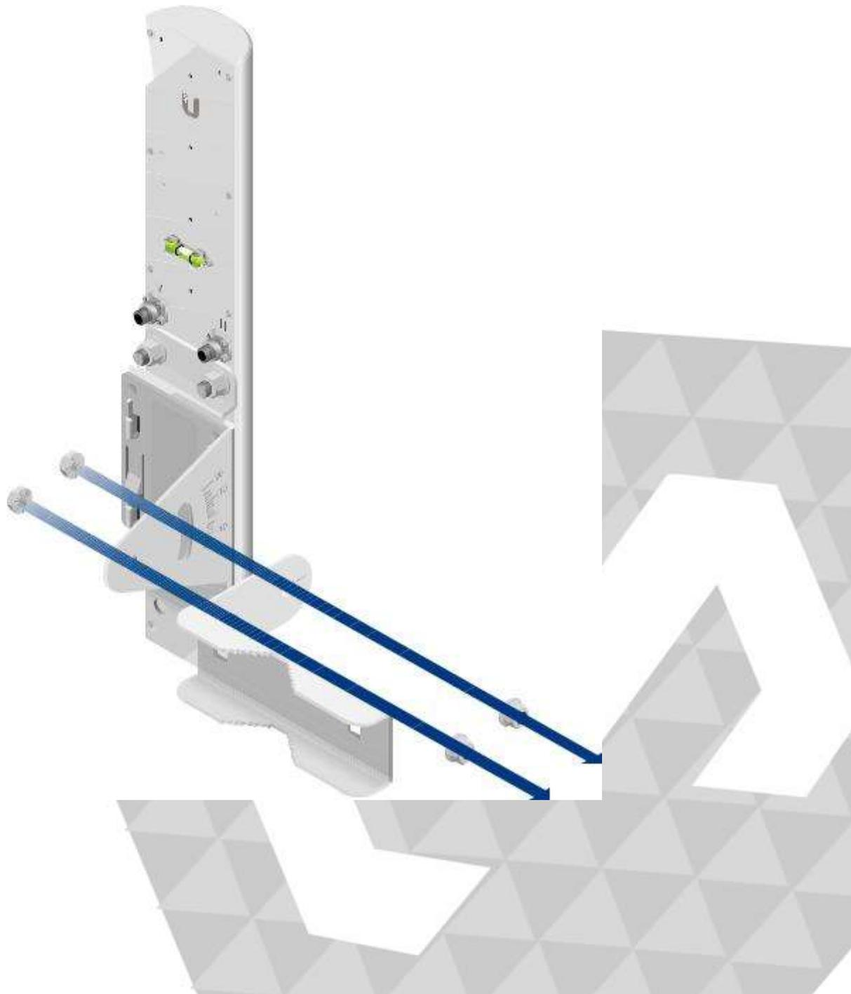
3. Conecte os cabos de RF aos conectores rotulados V e H na antena.
