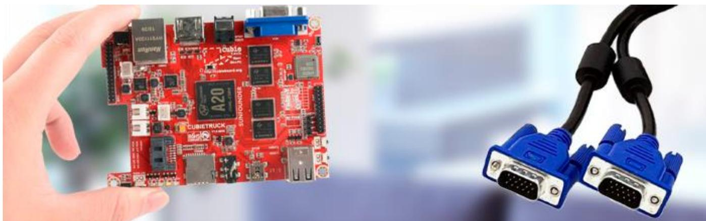
Neste post vamos ensinar como instalar a imagem VGA para cubietruck, também conhecida como cubieboard 3, um embarcado bastante robusto com processamento dual-core, 2 GB de memória RAM e 8 GB de memória flash (NAND) para armazenamento. Se você chegou até este tutorial é porque assim como eu é um fã de embarcado e tudo que essa tecnologia possibilita.
